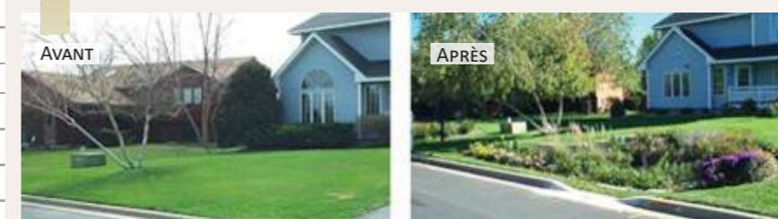
Ces nouvelles plates-bandes absorbent les eaux du toit et du caniveau.
